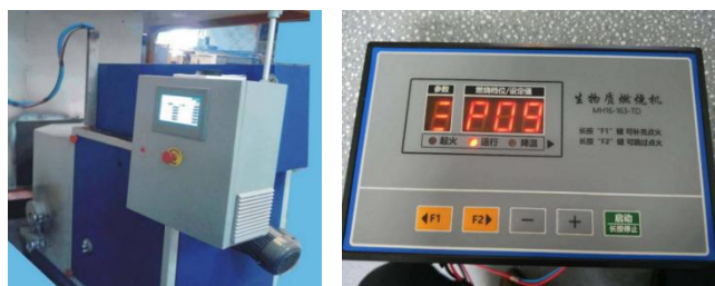
(a) 研发的生物质燃烧机智能控制系统
