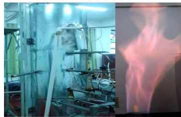
图 2 下吸分流式固定床秸秆气化炉实验装置（左图） 富氢燃气火焰图像（右图）
