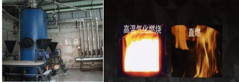
图 1 生物质高温热解气化燃烧装置
